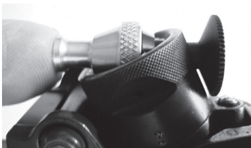
Bild 5: Farbfiltersystem Wyss, aufsteckbar
